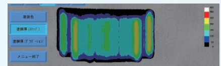
段階的な色分けで塗膜厚を表示
